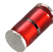
SPG : BK13000702-M 尺寸 : 6.0*3.3(mm) 工作電壓 : 140V 標稱放電電流 : 3kA(8/20 \mu s)
