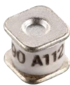
GDT : 2RK075M-4 尺寸 : 4.2*4.0(mm) 工作電壓 : 75V 標稱放電電流 : 3kA(8/20 \mu s)
